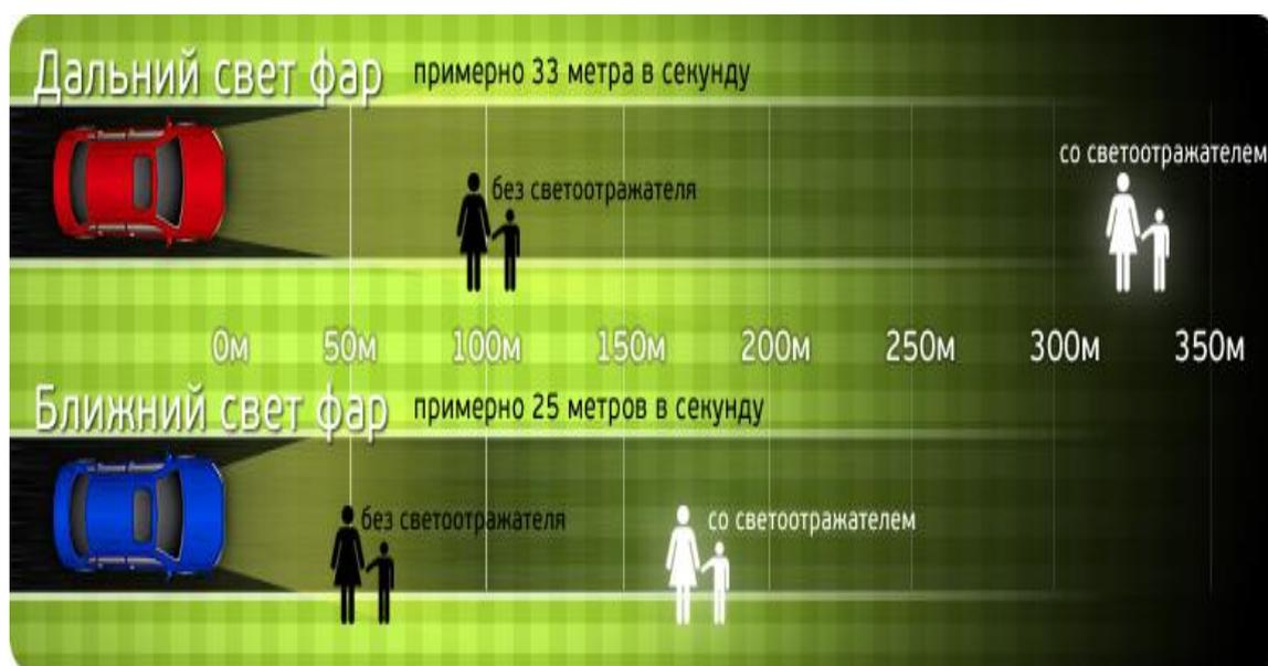
Соответствующий назначению светоотражатель должен иметь достаточно светоотражающую поверхность. Согласно CE-стандарту EN 13356, минимальное требование для значений светоотражения составляет 400 C.I.L.
